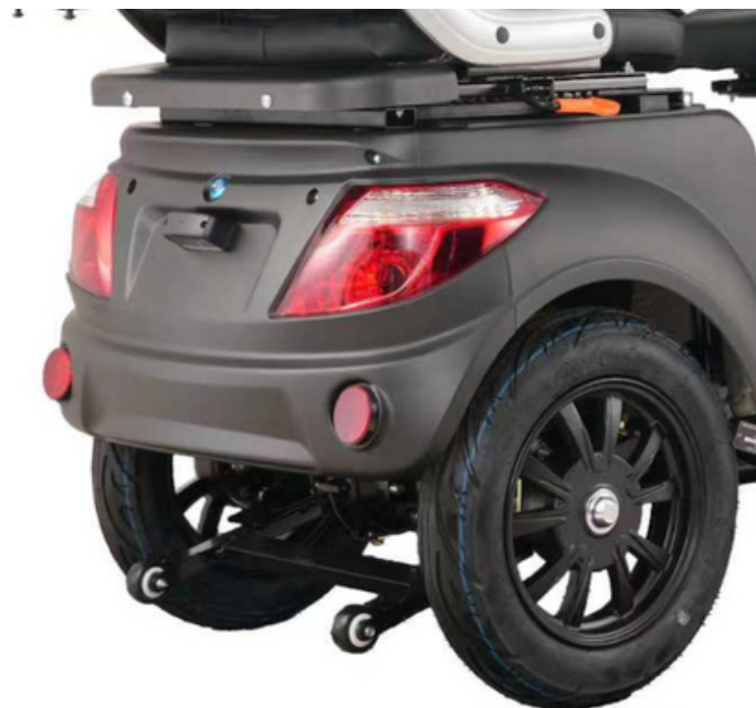
Fig. 1.11 Représentation schématique des roues anti-basculement/de support
